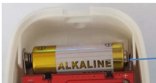
Zabezpieczenie przed rozładowaniem baterii
