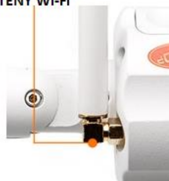
MIEJSCE MONTAŻU ANTENY WI-FI
